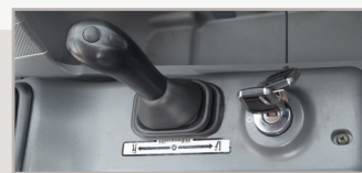
Schakelaar voor zwevend dozerblad en rijmodus
